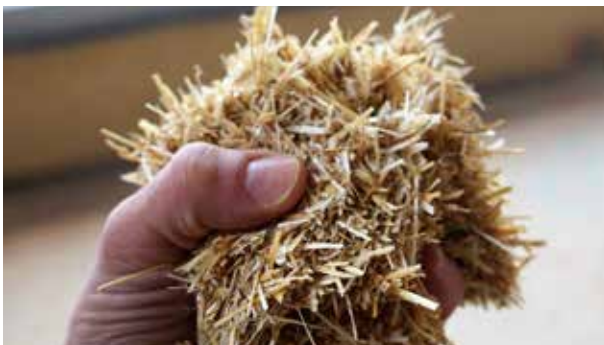
» Kleingeschnittenes Stroh als Einblasdämmung.
