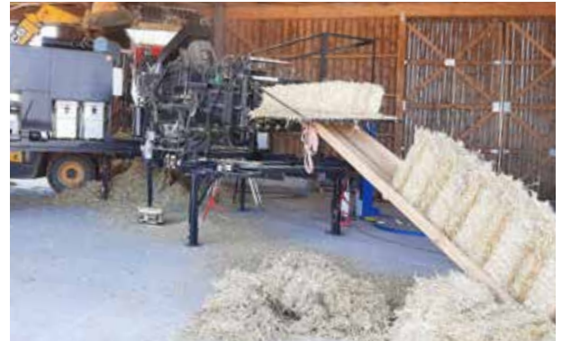
» Mobile Baustroh-Aufbereitungsanlage bzw. Strohpresse.
