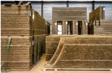
Stampflehmfertigteile bei der Trocknung
