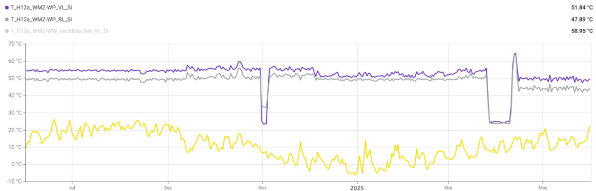
Abbildung 71: Temperaturverlauf VL und RL ab Wärmepumpe (zwischen WP und Speicher); 01. Juni 2024 bis 31.05.25; Tagesmittelwerte
