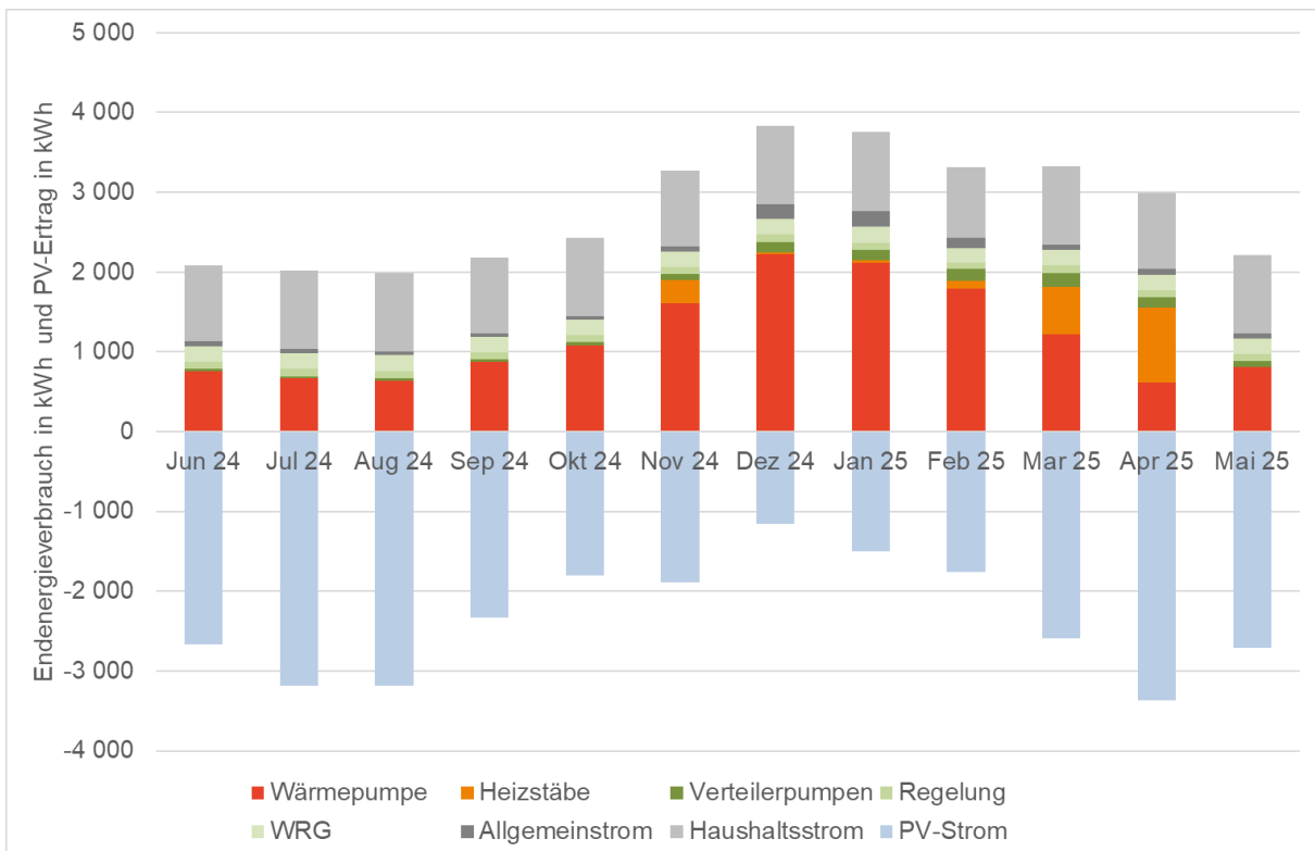
Abbildung 86: Endenergieverbrauch nach Anwendung und PV-Stromertrag; Haus 12a; Monatswerte
