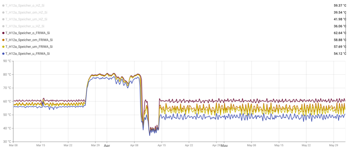
Abbildung 117: Temperaturverläufe im Warmwasserspeicher in vier Höhen vom 08.03.25 bis zum 31.05.25; Haus 12a; Quelle: Siemens-MSR; 5-Stundenmittelwerte
