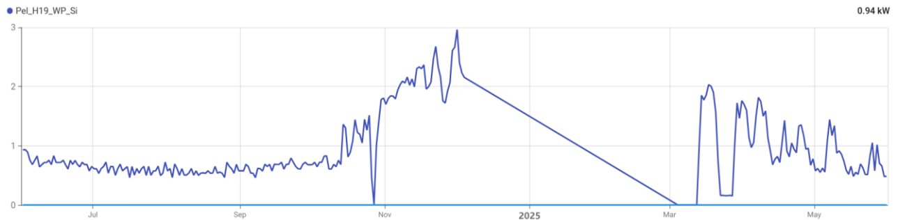
Abbildung 129: Haus 19, el. Leistung Wärmepumpe, Juni 2024 bis Mai 2025, Tagesmittelwerte
