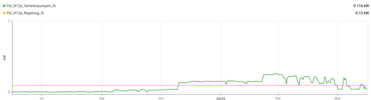
Abbildung 63: Haus 12a, el. Leistung Verteilerpumpen und Siemens Regelung Juni 2024 bis Mai 2025, Tagesmittelwerte; Quelle: Siemens MSR
