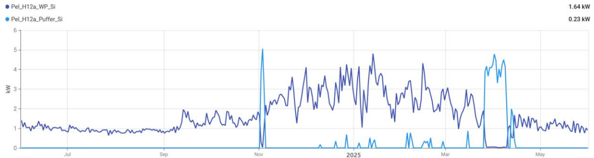
Abbildung 60: Haus 12a, el. Leistung Wärmepumpe und Heizstäbe, Juni 2024 bis Mai 2025, Tagesmittelwerte; Quelle: Siemens MSR
