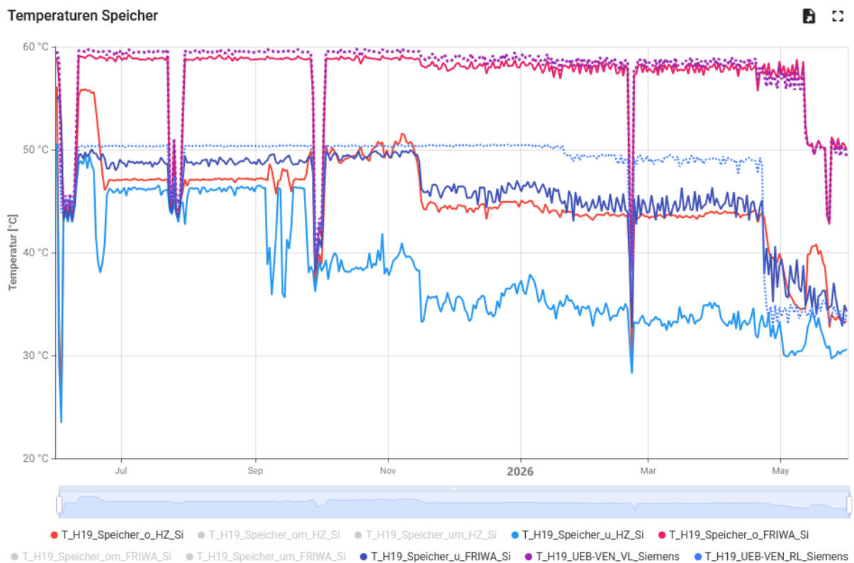
Abbildung 104: Haus 19 Temperaturverläufe im Heizungsspeicher und im Speicher der Warmwasserbereitung
