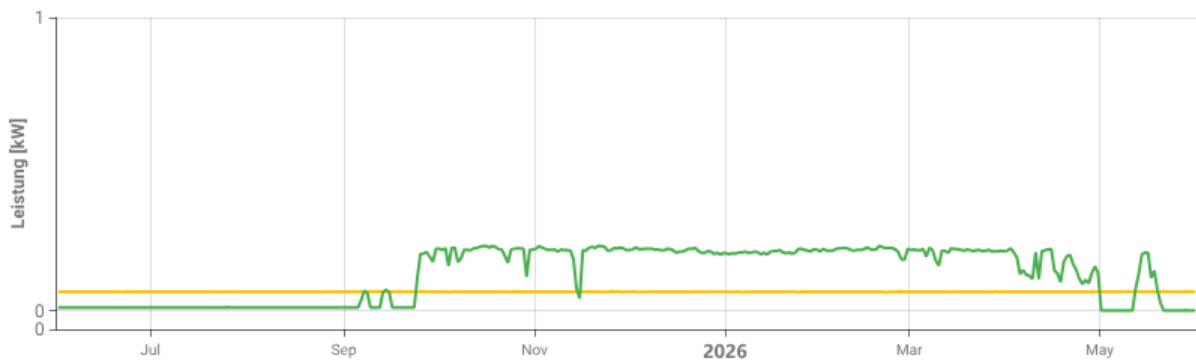
Abbildung 53: Haus 12a, el. Leistung Verteilerpumpen und Siemens Regelung Juni 2025 bis Mai 2026, Tagesmittelwerte; Quelle: Siemens MSR
