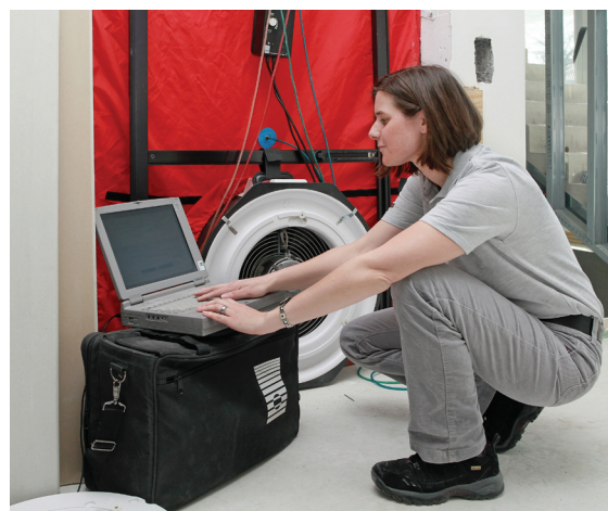
» Die Luftdichtheit eines Gebäudes wird mithilfe eines sogenannten „Blower Door-Tests“ gemessen.
