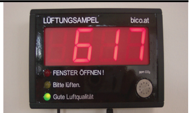
Lüftungsampel - misst die Kohlendioxidbelastung (CO 2 ) in ppm als Schadstoffindikator des Raumes
